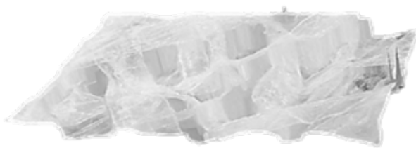
Рис. 3. Микроскопическое изображение структуры листовой бумаги (вид сверху)
