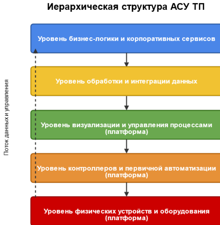
Рис. 2. Пятиуровневая иерархическая архитектура платформы АСУ ТП
