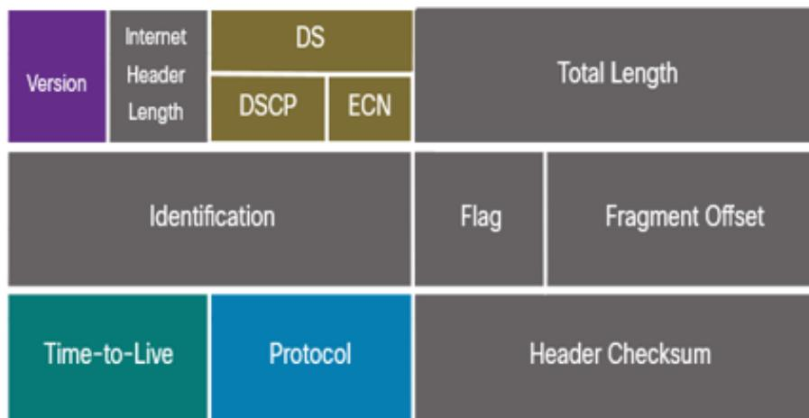
Рис. 1. Фрагмент заголовка пакета сетевого протокола IPv4
