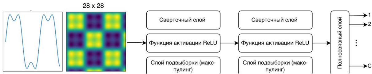
Рис. 2. Архитектура сверточной нейронной сети для классификации временных рядов (преобразование сигнала в изображение и последовательность слоев CNN) (составлено авторами на основе разработанной модели)
