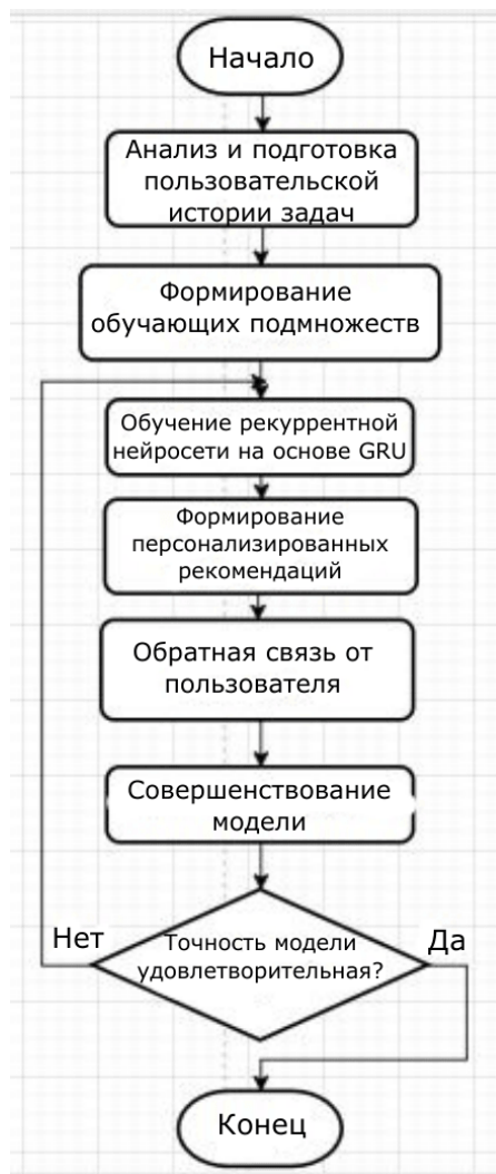
Рис. 2. Блок-схема алгоритма прогнозирования, учитывающего предыдущие пользовательские задачи
