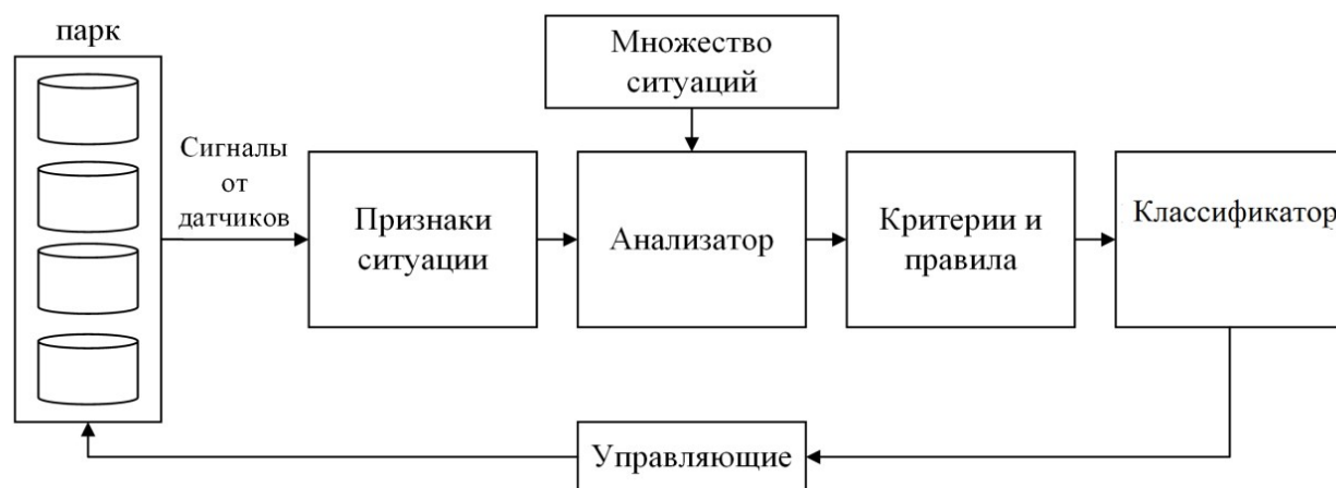
Рис. 2. Система ситуационного управления резервуарным парком
