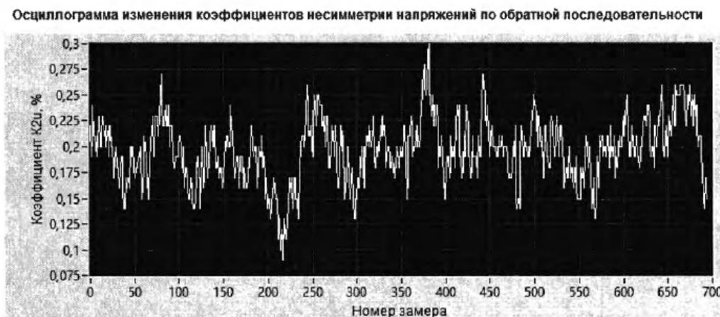
Рис. 6. Пример представления массива данных в виде осциллограммы
