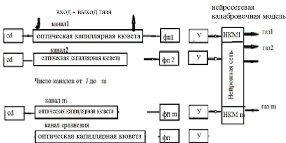
Рис. 1. Оптический сенсор на капиллярных волокнах
