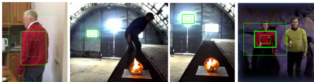
Рис. 12. Примеры отсутствия ложных срабатываний на других объектах видеоизображений. Наличие огня в подозреваемой области не подтверждено
