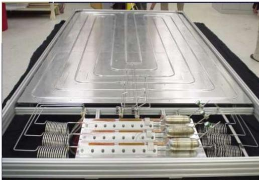
**Рис. 1.** Терморегуляция на космическом корабле: движение жидкости в тепловых трубках под действием капиллярных сил
