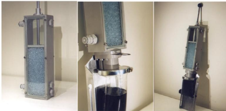
Рис. 4. Экспериментальная ячейка
